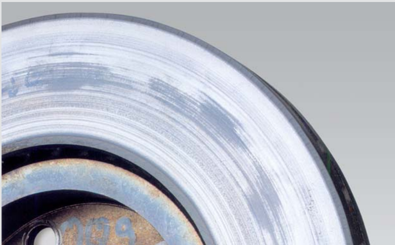
► örtlich überhitzte Bremsscheibe mit „Rubbleflecken“
