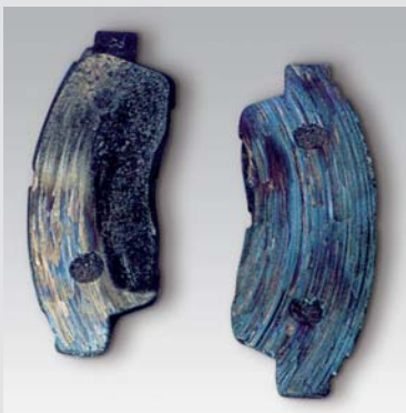
► Reibwerkstoff bis auf den Stahlträger verschlissen
